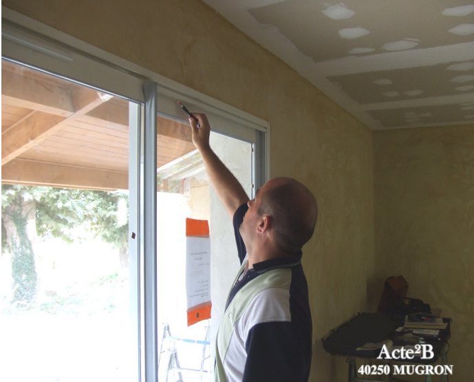
Recherche de fuites d'air lors d'un test intermédiaire avec un générateur de fumée
