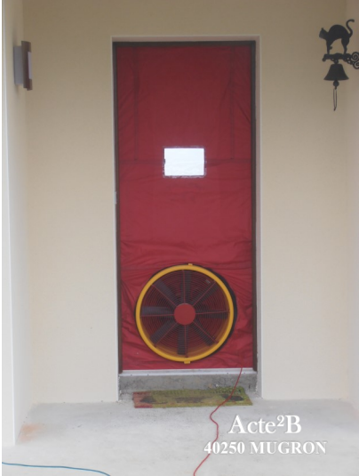
Dispositif de mesure et de mise en pressurisation/dépressurisation d'un bâtiment utilisé lors d'un test
